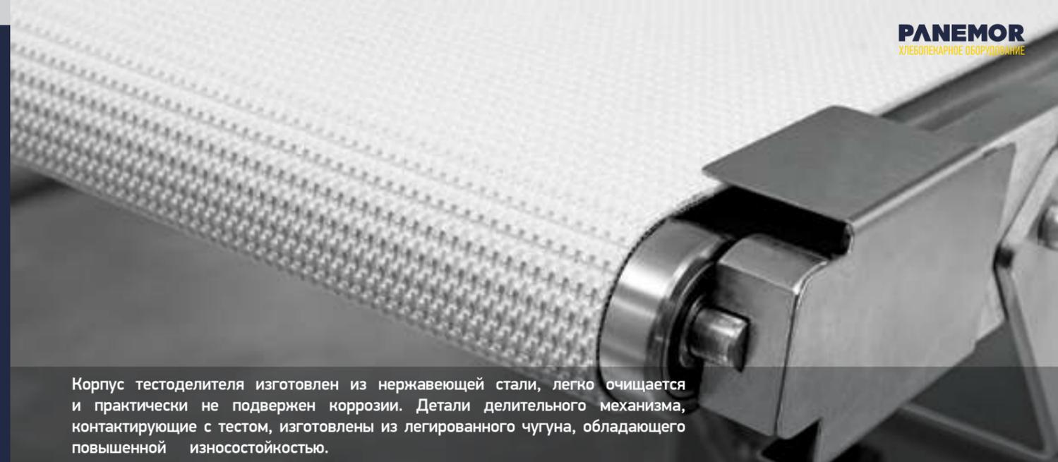
Корпус тестоделителя изготовлен из нержавеющей стали, легко очищается и практически не подвержен коррозии. Детали делительного механизма, контактирующие с тестом, изготовлены из легированного чугуна, обладающего повышенной износостойкостью.
