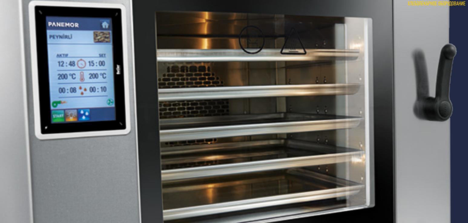
Принцип работы печи основан на конвекции горячих потоков воздуха. Используется принцип конвекции-принудительного распределения горячего воздуха по всему объему камеры выпекания. Воздух нагревается специальными элементами, в зависимости от типа топлива используемого в качестве теплоносителя, это может быть или электрический ТЭН, или газовая горелка. После расположенные в стенке вентиляторы и хорошо продуманная система воздуховодов
