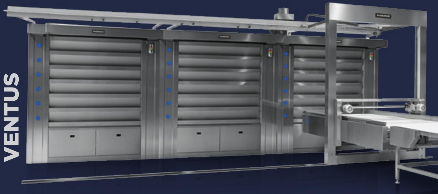
В сравнении с циклотермическими печами использование паротрубной технологии предлагает на 30 % меньшее потребление энергии. Благодаря циркуляции пара в трубах, печи имеют стабильность температуры, но и способны быстро реагировать на нагревание – около 5-9 °C в минуту. Также легко обеспечивают оптимальную температурную кривую в диапазоне 250–300 °C, необходимую для выпечки ржаного и пшенично-ржаного хлеба.
